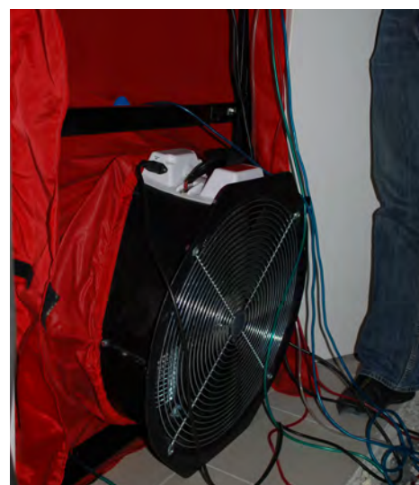
Blower Door Test - Picture: Tatiana De Meester
